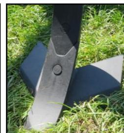
Le déchaumeur TOP est équipé de dents de 840x60x25mm réparties sur 3 rangées, montées sur un châssis robuste. Il est principalement destiné aux déchaumages (avec les ailettes, 10 à 15cm) et aux travaux de pseudo-labour (sans les ailettes, 20 à 30 cm). Les ailettes et les versoirs de la dent permettent un meilleur mélange. La disposition en 3 rangées de dents permet un meilleur écoulement des résidus végétaux.
