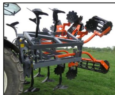
Le déchaumeur KUS est équipé de dents de 850 x 60 x 25 mm réparties sur 2 rangées, montées sur un châssis robuste de 100 x 100 x 8 mm. Il est principalement destiné aux déchaumages (10 à 15 cm) et aux reprises de labours. Les dents sont constituées d'un soc, d'ailettes et d'un versoir, ce qui permet un meilleur mélange.
