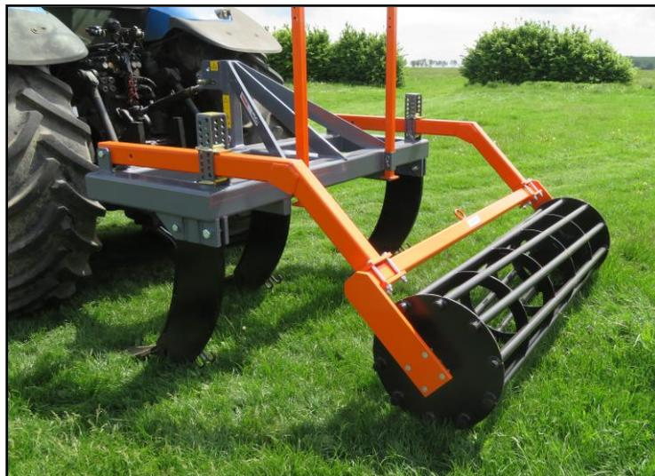
Les décompacteurs MG sont utilisés pour travailler les sols en profondeur, notamment quand ils sont trop tassés. Ces outils permettent une meilleure aération des sols. Le sol est « ouvert » en profondeur, sans déformation en surface.
