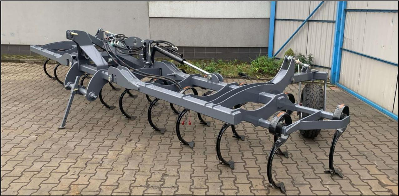
Le cultivateur KUN FRONT est un cultivateur frontal. Il peut être utilisé en combiné avec un déchaumeur à disques ou bien un semoir à l'arrière du tracteur. Cet outil est équipé de dents de 70x12 montées sur 4 rangées.
