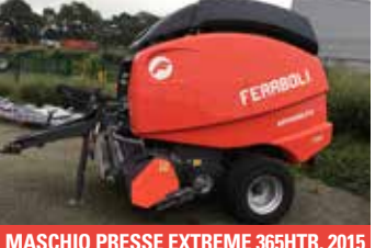
MASCHIO PRESSE EXTREME 365HTR, 2015 Chambre variable, P.U. 2,20 m, ameneur rotatif, liage filet, roues 19.0/45x17, boîtier de commande Icon multifonctions. 24 086 €HT - Démonstration 19 990 €HT
