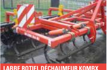
LABBE ROTIEL DÉCHAUMEUR KOMBX Largeur 3,30 m, 2 rangées de dents carré de 40, sécurité non stop à double ressorts, 1 rangée de disques niveleurs Ø510 mm, rouleau cage Ø540 mm. 8 736 €HT - Démonstration 6 990 €HT
