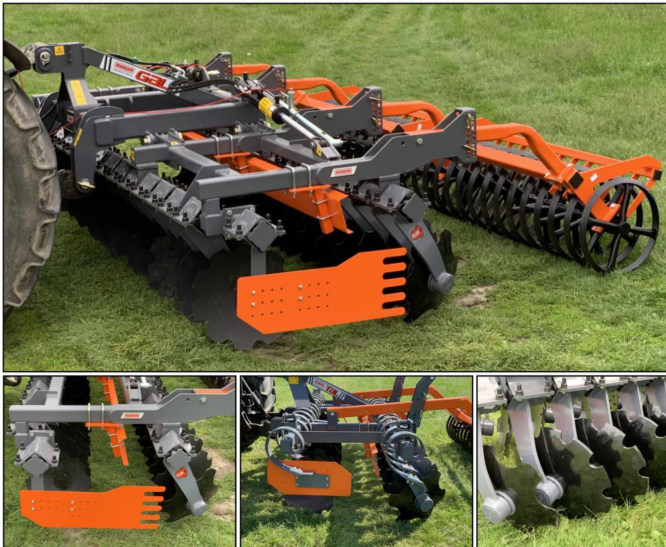
Les déchaumeurs GAL et TAL sont équipés de 2 rangées de disques sur paliers sans entretiens, indépendants, de  $\varnothing$  560mm ( $\varnothing$  610mm en option). Ces déchaumeurs sont disponibles avec sécurité « boudins caoutchouc » ou sécurité « lames ressort ». Ils sont destinés à un travail de déchaumage et de faux semis, idéals dans les terrains sales ou en premier passage...
