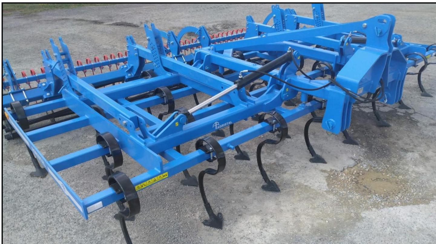
Le vibro-déchaumeur AGRISTAL est conçu pour des utilisations variées : déchaumages, faux-semis, reprises de labours, préparations de semis. Cet outil est équipé de dents de 70x12 montées sur 4 rangées de 70x70x6mm. Il s'agit d'un outil très simplement monté, robuste, pratique à l'utilisation et l'entretien.
